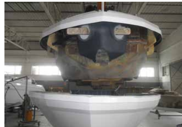
La fase di chiusura (o accoppiamento) di guscio e coperta, una delle più delicate di tutta la fase di costruzione
