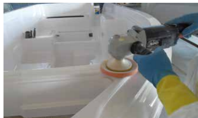
La lucidatura finale che dà brillantezza allo scafo. Anche questa fase viene eseguita a mano da personale altamente qualificato
