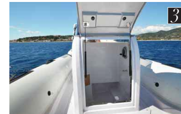
1. Il gavone sotto al prendisole di prua per stivare borse e cambusa. 2. Il mobile a poppavia della consolle ospita una cucina con lavello e lo spazio per il piano cottura.
