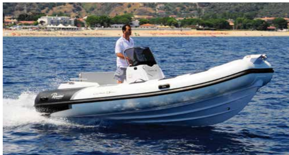
La carena è armata con doppio spray deflector per ogni piano di scivolamento, e la ruota di prua è mediamente avanzata per offrire buon contrasto alle onde
