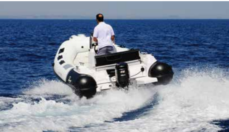
In virata il battello pneumatico offre saggio delle sue doti di tenuta, poggiando il tubolare interno ed accompagnando la traiettoria
