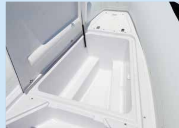
Il gavone grande di prua è scafandrato internamente e pertanto può anche essere usato come vasca per il contenimento del pescato
