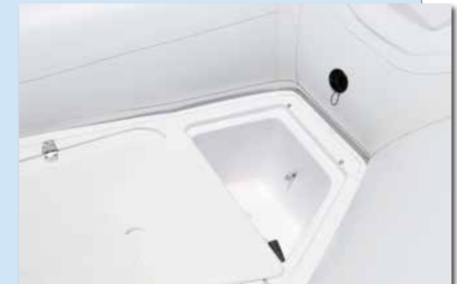
Il gavoncino dell'ancora è anch'esso scafandrato. Nel caso d'installazione del salpancora contiene solo il calumo
