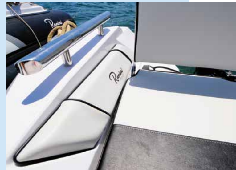
Le spallette in vetroresina sopra i tubolari a poppa ospitano i maniglioni in acciaio ma possono anche accogliere portacanne a staffa o roll bar
