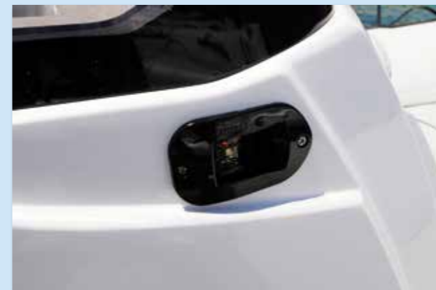
Le luci di navigazione rossa e verde sono incastonate nella console di pilotaggio. La bianca è a staffa da innestare a poppa
