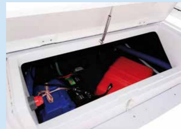
Il gavone di poppa ove, oltre alla batteria, trova posto la pompa di sentina automatica ed il serbatoio opzionale del carburante
