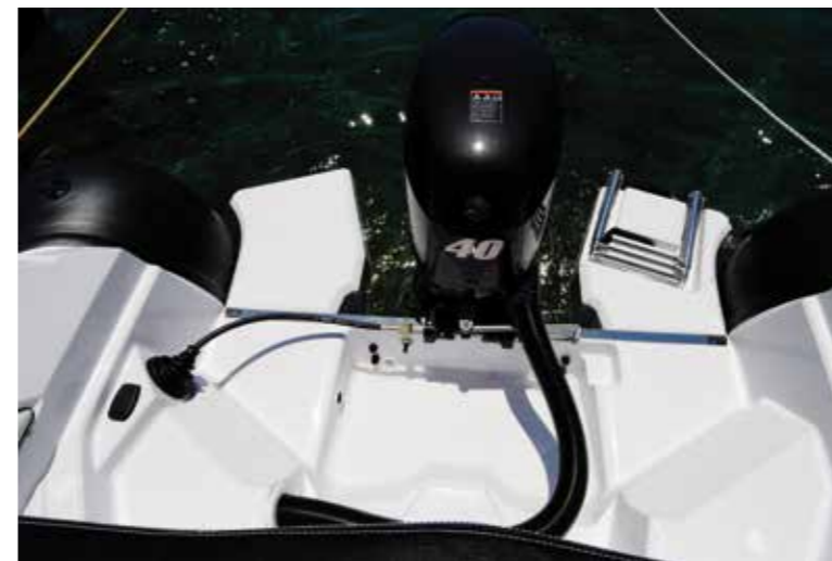
La coppia di plancette di poppa fornite di serie. Una di queste supporta la scaletta bagno telescopica, l'altra è totalmente libera e calpestabile
